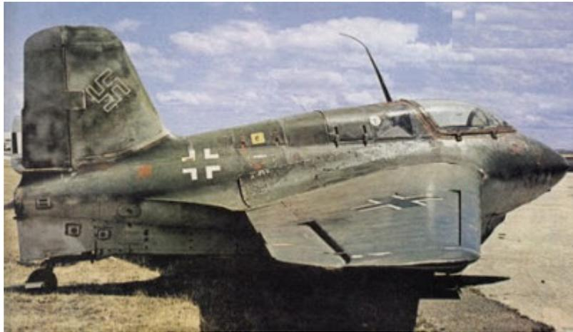
Questo aereo avrebbe battuto ogni record di velocità, arrivando a 1,004 km/h, ma, sul teatro operativo, si rivelò un fallimento; le sue riserve di munizioni e il carburante erano estremamente scarsi e spesso si esaurivano prima del combattimento. Inoltre l'aereo tornava alla base planando come un aliante e questo lo rendeva vulnerabile ai caccia alleati.
